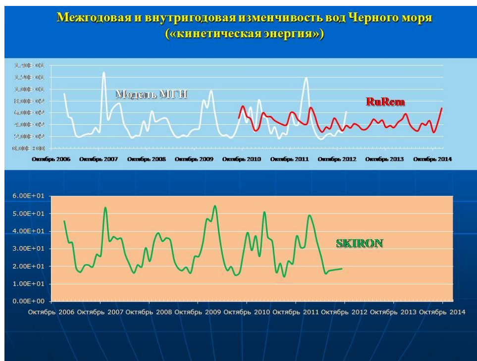
Рис. 4. График временной изменчивости кинетической энергии поверхностных течений (общечерноморская модель МГИ, горизонтальное разрешение \sim 5 км, и региональная модель СВ-области моря RuRem, горизонтальное разрешение \sim 1 км) и ветра (модель SKIRON, Греция) за период 2010-2014 гг. Модельные данные, средние значения по региону.
